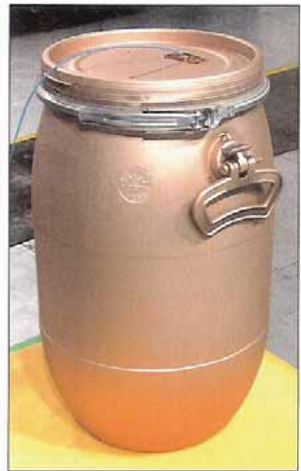
Abb. 3: Polyethylen Deckelfass mit AgCu-Beschichtung (Partikelanteil 20 Vol.%, Schichtdicke 50 \mu m ) mit bereits eingebautem Empfänger
