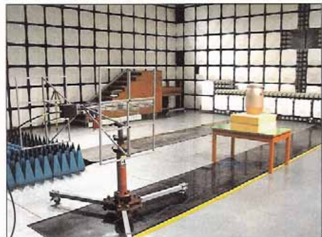
Abb. 2: Überblick über den Aufbau der EMS-Messung in der abgeschirmten Absorberhalle
